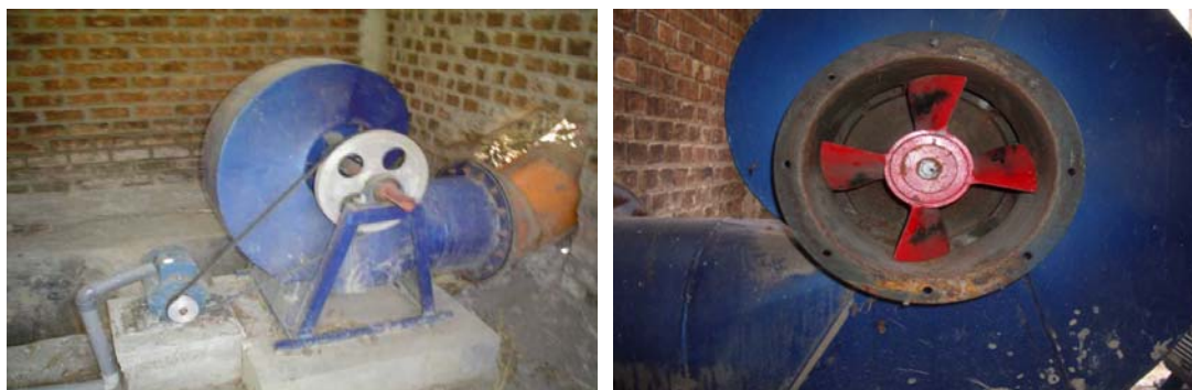
Foto 2 y 3: Turbina axial de Magdalena, rodete sin modelación en CFD
