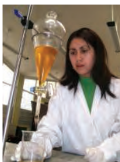
Separación manual del biodiésel.
