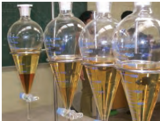
Separación de fases biodiésel / glicerina.
