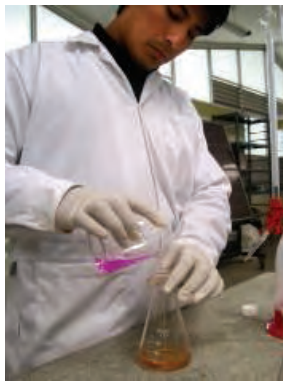
Preparando muestra de aceite para titular.
