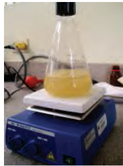
Cambio de color del aceite en los primeros segundos de mezcla.
