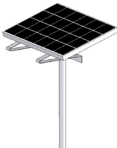
Ilustración 23: Forma de instalación del panel fotovoltaico
