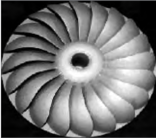
Figura 97. Rodete de una turbina Turgo
